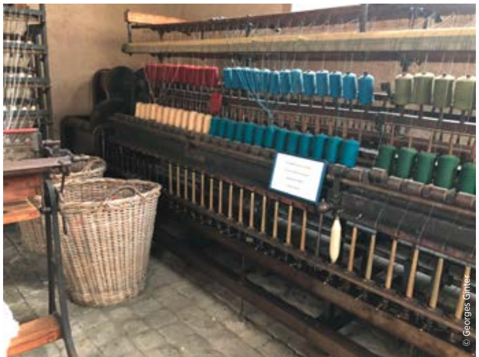
Zwess ( retordeuse/Zwirnereimaschine ): Twister fir zwee oder dräi Fiedem beieneen ze dréinen
